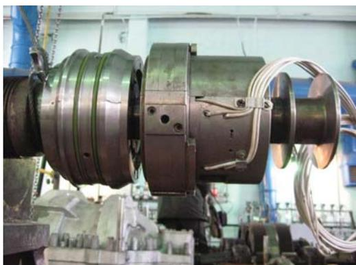
Nuevo sello seco de gas en el rotor del compresor, listo para ser instalado.
